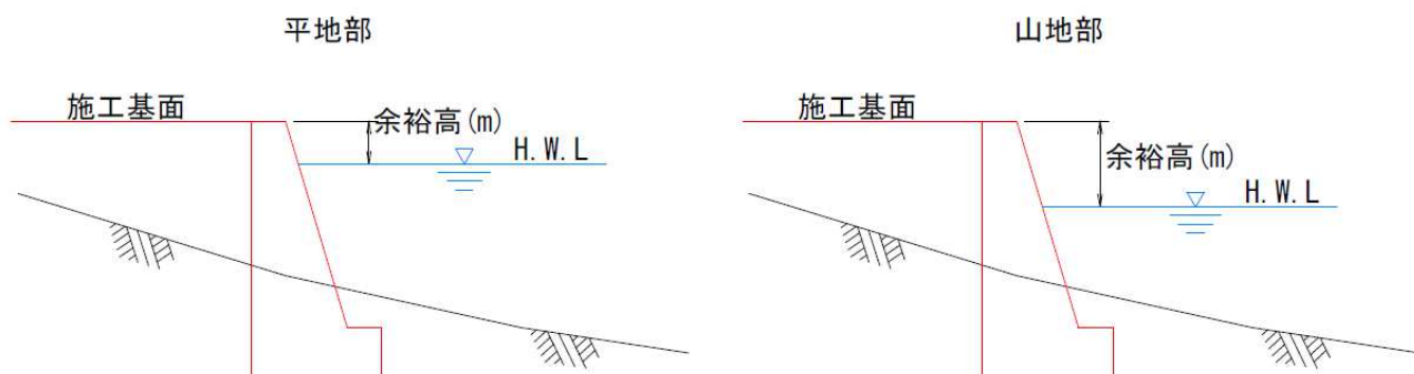
(図) 施工基面と天端の高さ
