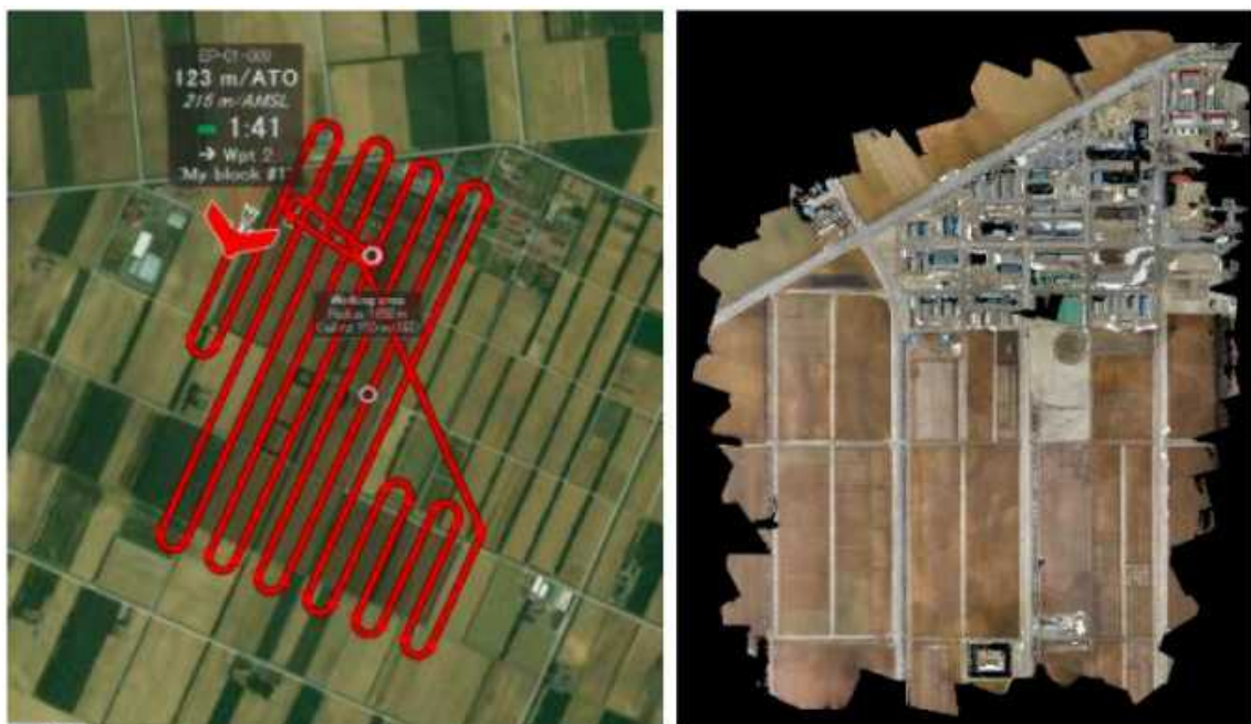
図4-8 ドローンによる広域撮影の例 (左：100ha 撮影時の飛行軌跡 右：撮影画像)
