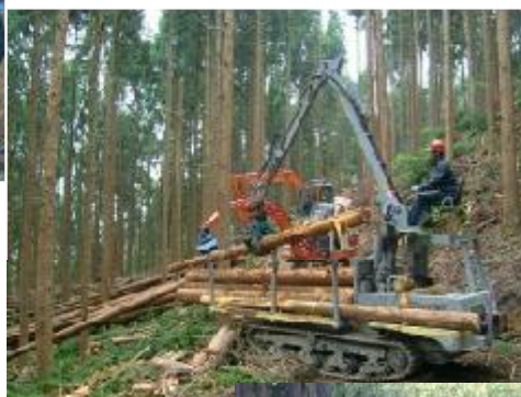
森林作業道を使い 高性能林業機械により 搬出間伐を実施
