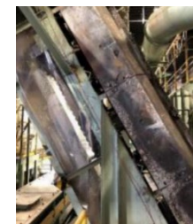
火災で焦げた破碎物コンベヤ（府中市）
