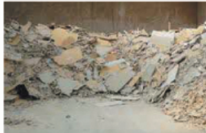
(石膏ボード廃材)
