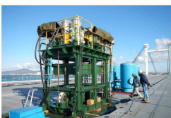
写真-13 桁振動実験
