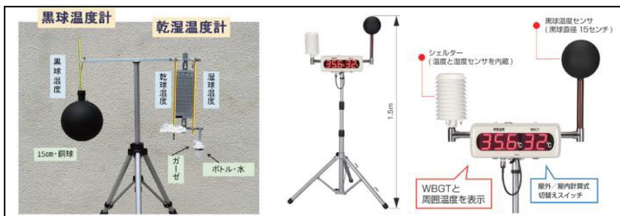
図 2-2 暑さ指数（WBGT）測定装置 左は基本型、右は電子式のもの（出典：環境省 17 ）
